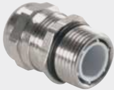
Σειρά UNI-EX Μετρικοί στυπιοθλίπτες με μακρύ σπείρωμα από επινικελωμένο ορείχαλκο IP66/IP68
