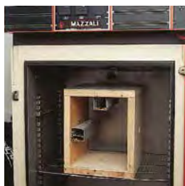
Cabin for age acceleration test. Chambre climatique pour le test de vieillissement accéléré.
