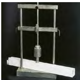
Apparatus for shock testing at low temperature. Équipement pour tester l'impact à basse température.
