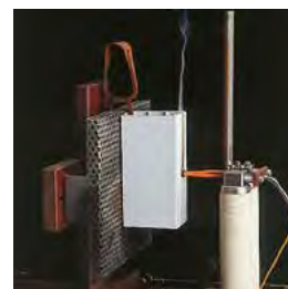
Apparatus for testing heat resistance (850°C) GWT. Résistance au fil incandescent 850°C.
