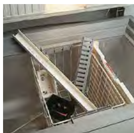
Refrigerator to prepare samples for low temperature shock tests. Chambre froide pour la climatisation à l'impact des éprouvettes à basse température.
