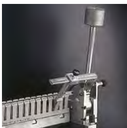
Apparatus for finger-removal and side-segment removal test. Essais d'équipement et sur le coté du segment retrait de la lame.
