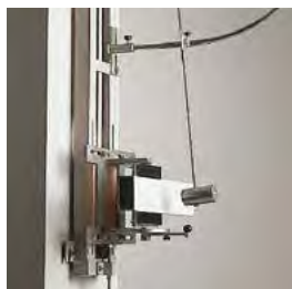
Apparatus for shock testing at room temperature. Équipement de test de choc à température ambiante.
