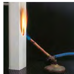
Apparatus for flame propagation resistance test. Équipement pour essais de résistance à la propagation des flammes.
